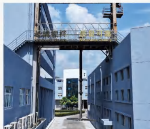
天桥试验台:高13m 长8m
